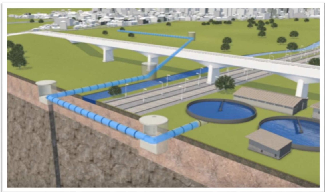
รูปที่ ๒ ลักษณะงานดันท่อ
