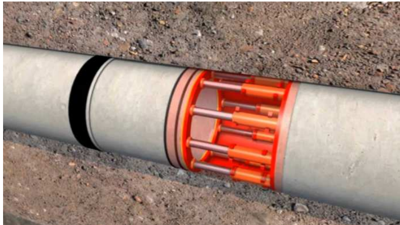
รูปที่ ๑๐ แม่แรงเสริม (Intermediate Jacks)
