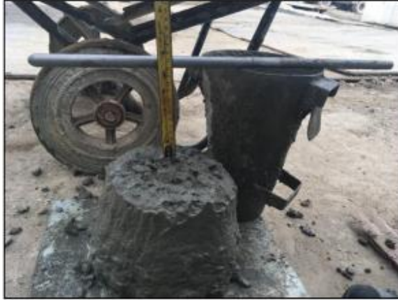
รูปที่ ๓๓ แสดงการทดสอบ Slump Test และการเทคอนกรีต Base Slab
