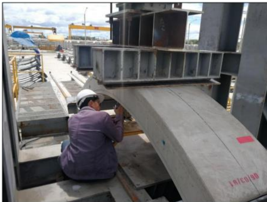
รูปที่ ๘ การติดตั้ง Dial Gauge สำหรับหาค่าเคลื่อนตัวแนวตั้งของชั้นทดสอบ
