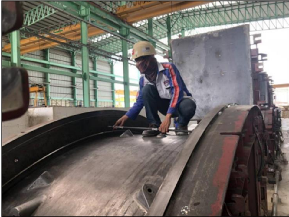
รูปที่ ๕ แสดงการวัดค่าความกว้างของโมลด้วยไมโครมิเตอร์
