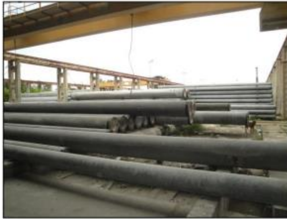
รูปที่ ๒๘ แสดงแท่นและอุปกรณ์ประกอบระบบการอัดแรง
