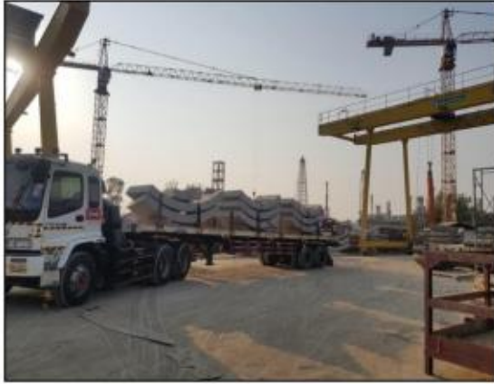
รูปที่ ๒๙ แสดงการขนส่งชิ้นส่วนอุโมงค์จากโรงงานผลิต และการขนส่งภายในอุโมงค์
