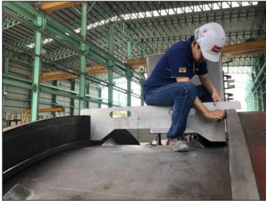
รูปที่ ๗ รูปแสดงการความกว้างของโมลด้วย Template และ Filler Gauge
