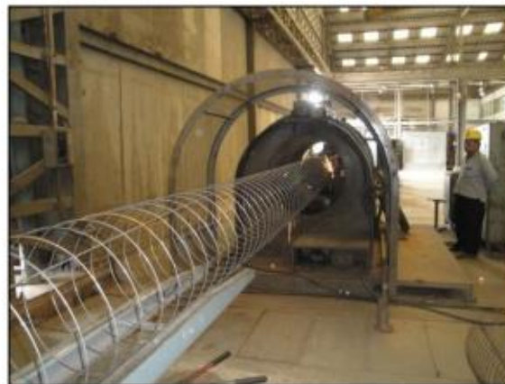
รูปที่ ๒๗ แสดงแท่นและอุปกรณ์ประกอบระบบการอัดแรง
