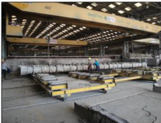
รูปที่ ๒๗ แสดงแท่นและอุปกรณ์ประกอบระบบการอัดแรง
