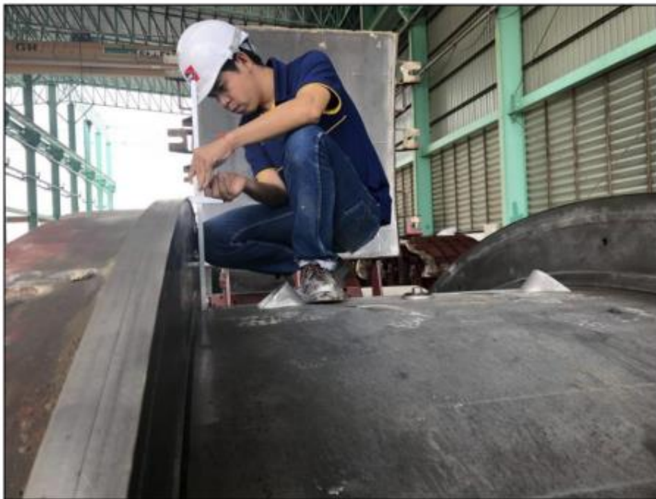
รูปที่ ๖ รูปแสดงการวัดค่าความหนาของโมลด้วย เวอร์เนียคาลิเปอร์
