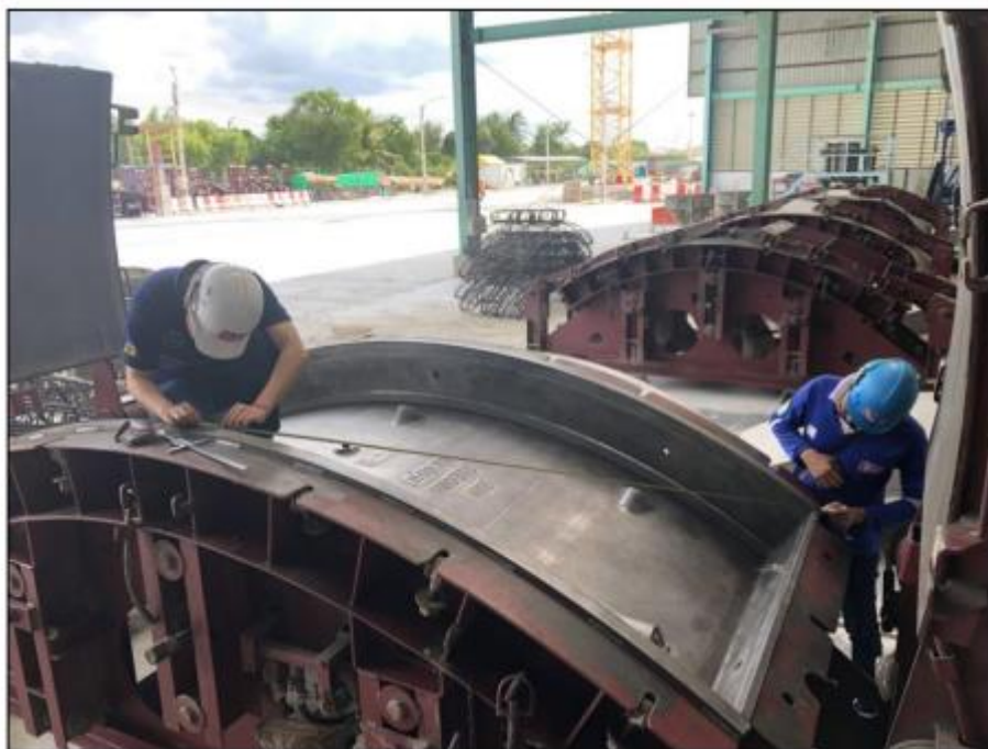
รูปที่ ๔ การวัดค่าแนวเส้นทแยงมุมจากจุดศูนย์กลางโค้งของโมล
