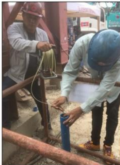
รูปที่ ๑๘ การตรวจวัดค่าการเคลื่อนตัวในแนวตั้ง (Extensometer)
