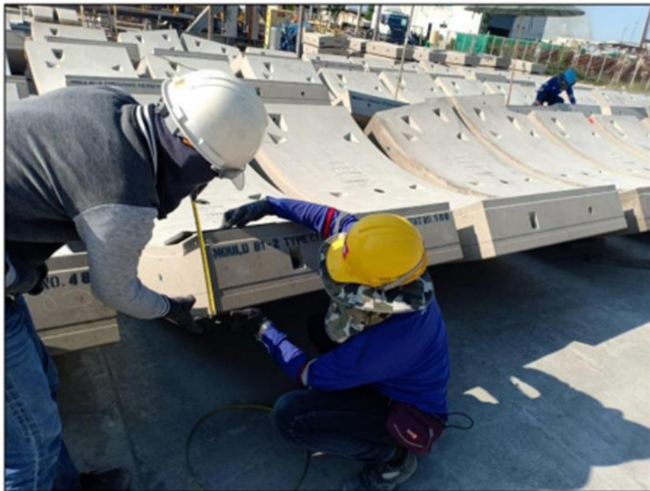
รูปที่ ๑๗ แสดงการวัดความหนา Segment
