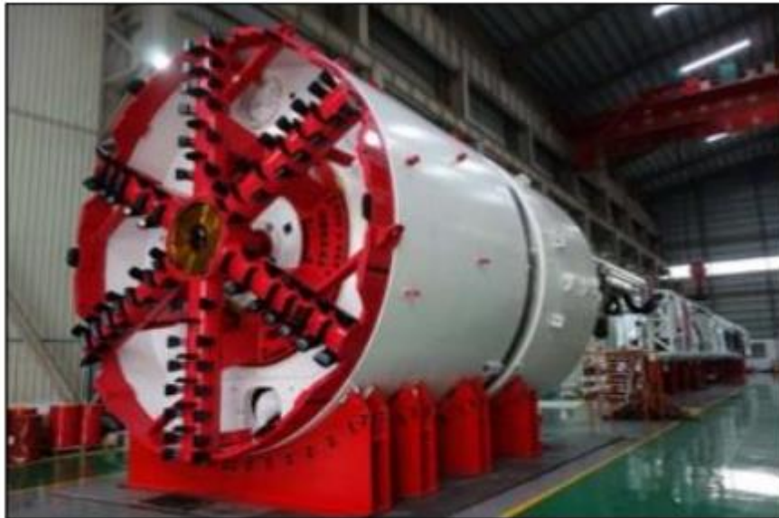
รูปที่ ๒๑ แสดงหัวเจาะอุโมงค์ระบบแรงดันดินสมดุลย์ EPB (Earth Pressure Balance)
