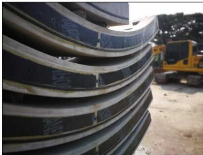
รูปที่ ๒ วัสดุ Hydro swelling และ Bituminous packing
