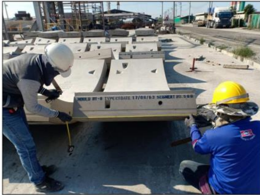
รูปที่ ๑๘ แสดงการวัดความกว้างของ Segment
